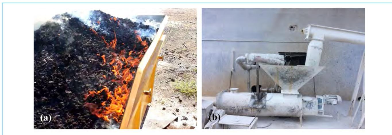
**Figura 6** – Problemas encontrados durante o processo de EA: (a) combustão do lodo misturado com a cal e (b) elevada liberação de poeiras.
